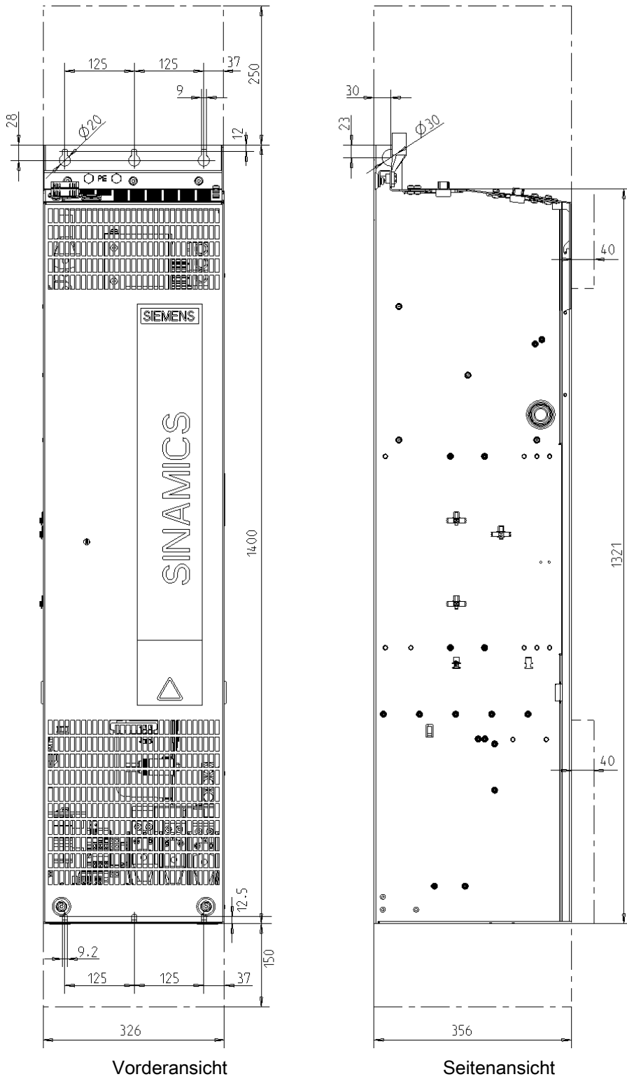
Bild 4-7 Maßbild Motor Module, Baugröße FX
