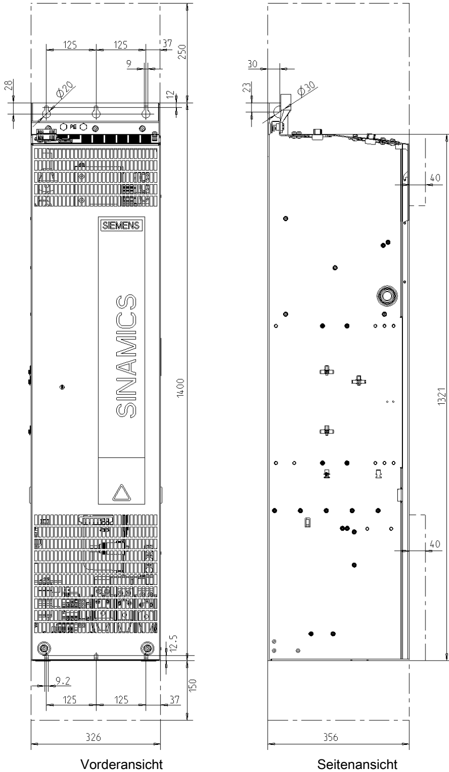
Bild 3-17 Maßbild Active Line Module, Baugröße FX
