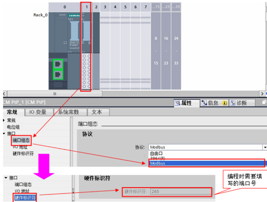
图 2-5 设置 ET200SP CM PTP 模块协议
