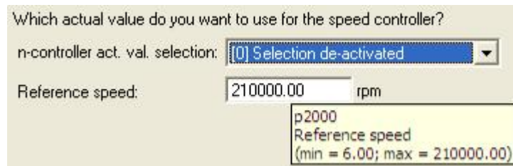
图 21 设置速度反馈方式和参考转速
