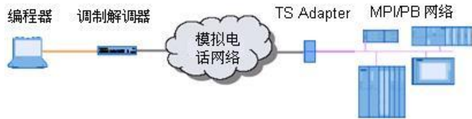
TS Adapter II 网络结构图
