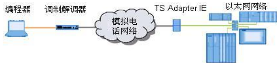
TS Adapter IE 网络结构图
