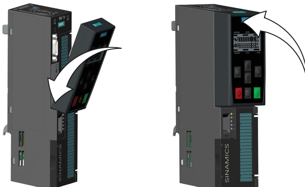
Figura 5-1 Inserimento del BOP-2 nella Control Unit
