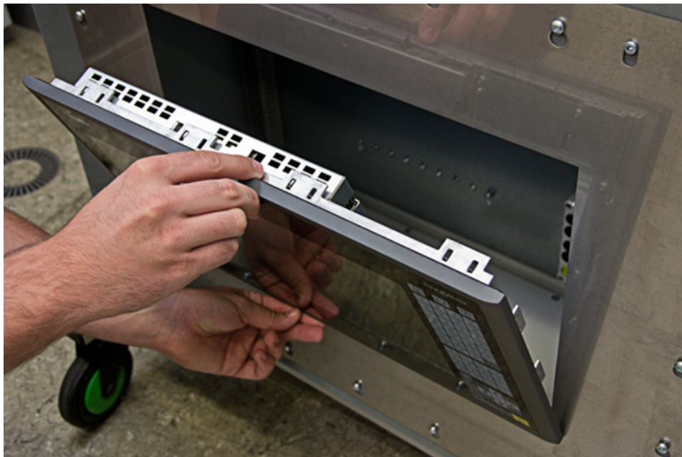
図 11-4 操作パネルの差し込み
