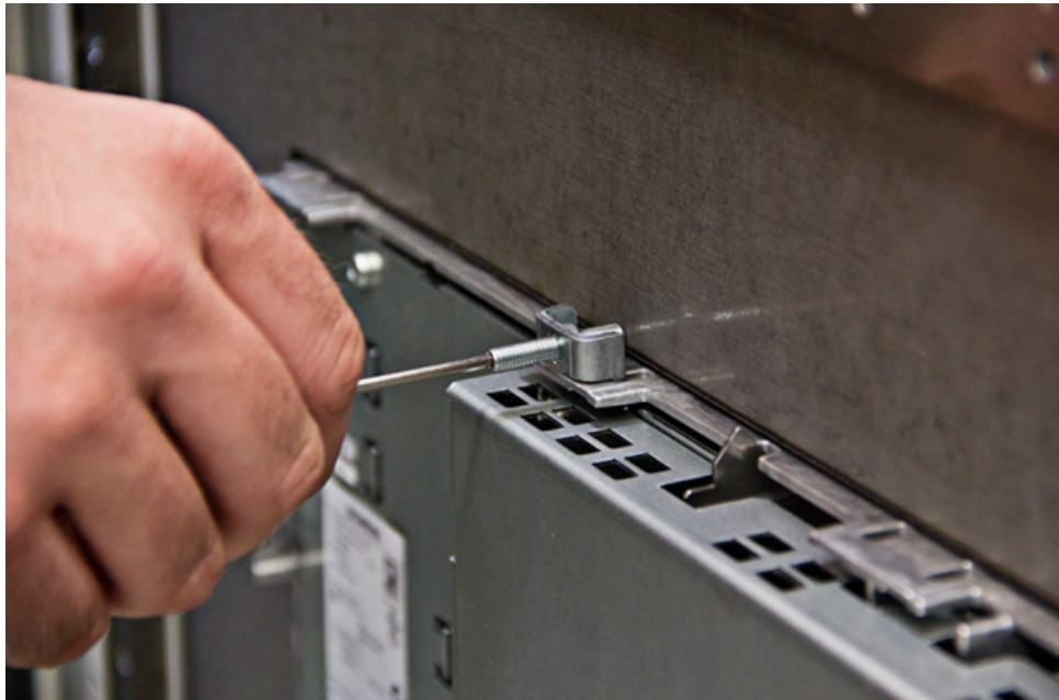
図 11-6 クランプ用固定器具を締める
