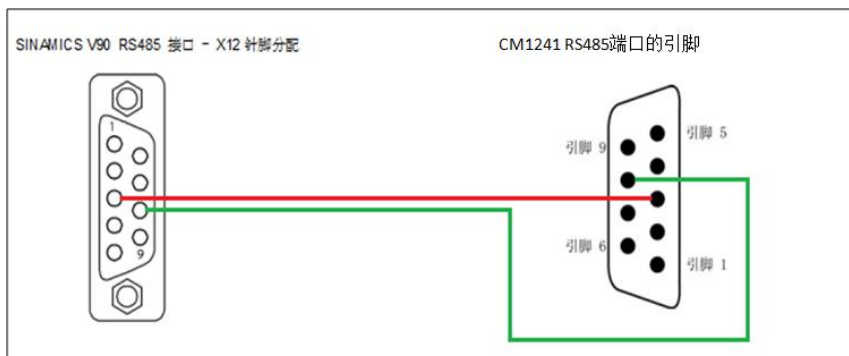
图 2-1 CM1241 RS485 与 V90 通讯线连接
