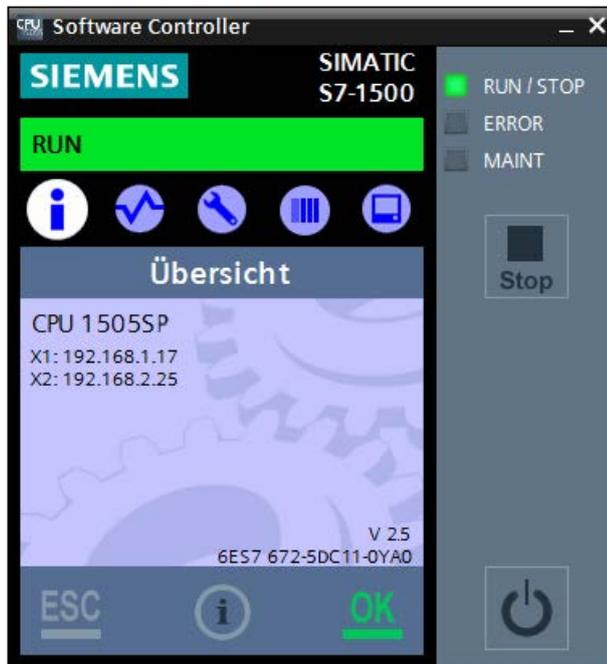
Bild 3-2 CPU im Betriebszustand RUN
