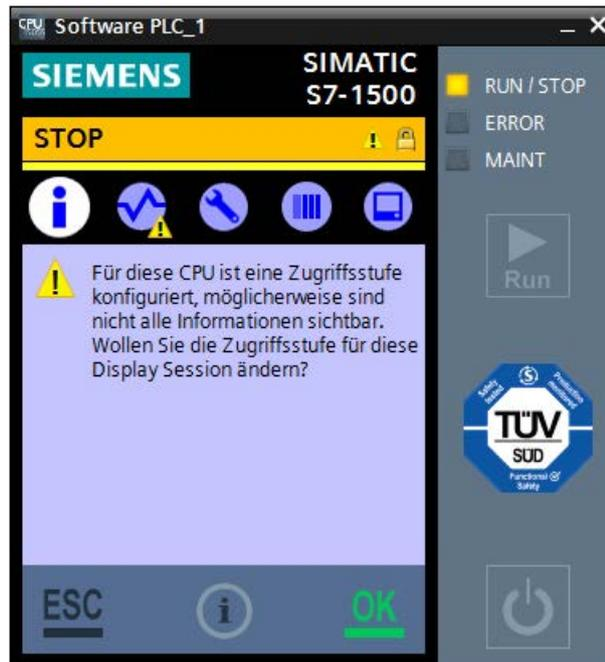
Bild 8-2 Display der CPU bei eingerichtem Passwort
