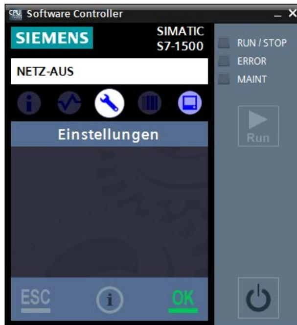
Bild 6-1 Display der CPU im Zustand "NETZ AUS"
