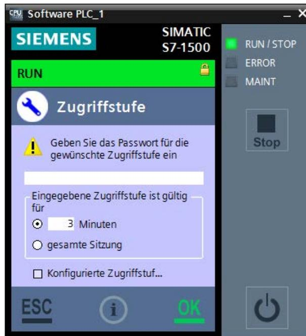
Bild 8-3 Passwort für Schutzstufe eingeben
