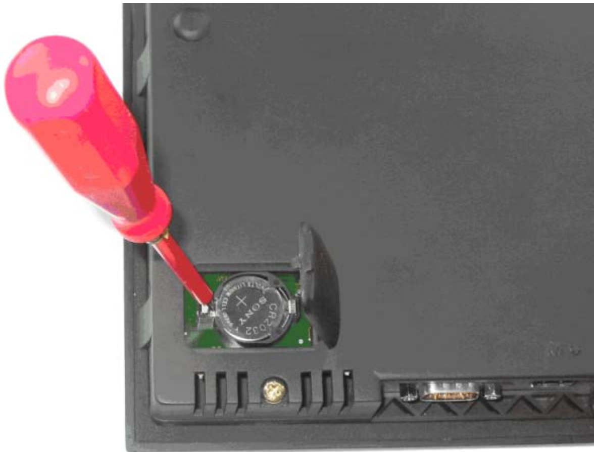
Esquema 11-23 Substituição da bateria tampão do painel de controle da unidade do armário
