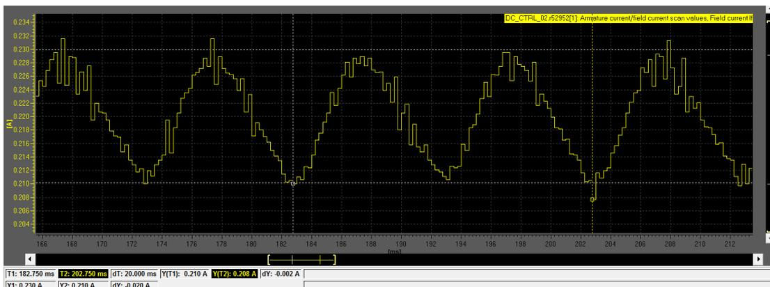
同理，参数 r52925.1（电机励磁电流）用于检查电机励磁电流是否正常。下图 2 所示为单相桥的励磁电流波形，在一个周期内的 2 个波头完整且连续为正常。
