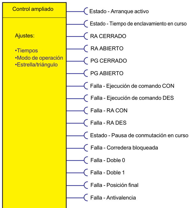
Figura 4-15 Bloque de función "Control ampliado"
