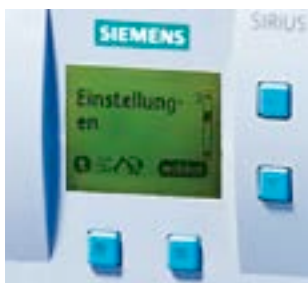
Einfache Benutzerführung durch das Keypad mit einem menügeführten, mehrzeiligen, grafischen Display
