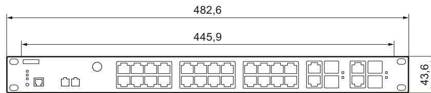
图 9-1 基于 24 V DC 变型示例的宽度和高度
