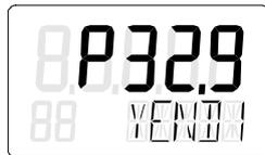
7. Defina la posición final inferior del cabezal de actuador.
