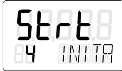
Durante la inicialización automática el posicionador recorre 5 niveles de inicialización. Los indicadores de los niveles de inicialización "RUN 1" a "RUN 5" aparecen en la línea inferior del display. El proceso de inicialización depende del actuador utilizado y dura máximo 15 minutos.
