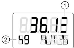
Figura 9-8 Indicación de un aviso de umbral 3 con tres barras (alarma de mantenimiento)
