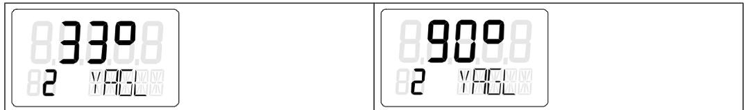
3. Compruebe si el valor indicado en el parámetro "2.YAGL" coincide con el ajuste del conmutador de la transmisión del engranaje. De ser necesario, corrija el ajuste del conmutador de la transmisión del engranaje a 33° ó 90°.
