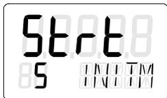
6. Al cabo de 5 segundos se muestra en el display la posición actual del potenciómetro:
