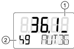
Figura 9-6 Indicación de un aviso de umbral 1 con una barra (mantenimiento necesario)
