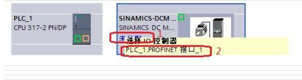
图 3-3 PROFINET 网络组态 1
