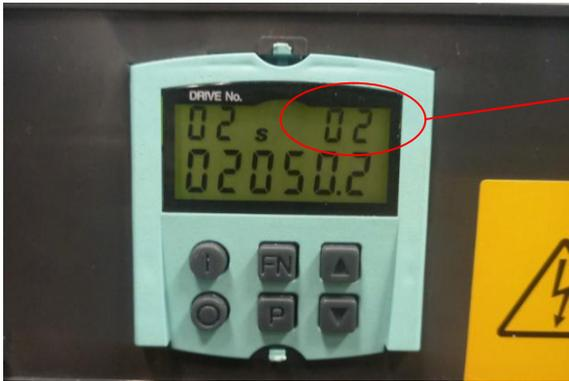
右上角改为 02，然后再修改参数，STARTER 软件中 p50603[0]=DC\_CTRL\_02 : r2050[2]，参数显示正常
