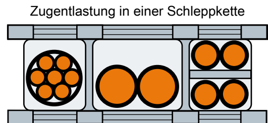
Zugentlastung in einer Schleppkette Leitungsverlegung in einer Schleppkette
