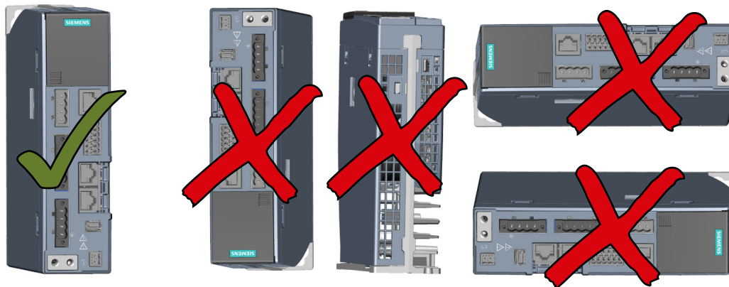
Bild 5-2 Einbaulage des Umrichters
