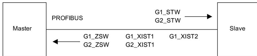
Figure 10-4 Example of encoder interface (encoder-1: Two actual values, encoder-2: One actual value)
