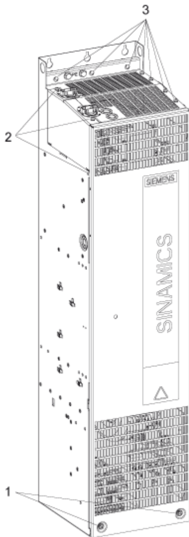
Bild 6-6 Montage des Braking Module in ein Power Module Baugröße FX – Schritt 1 - 3
