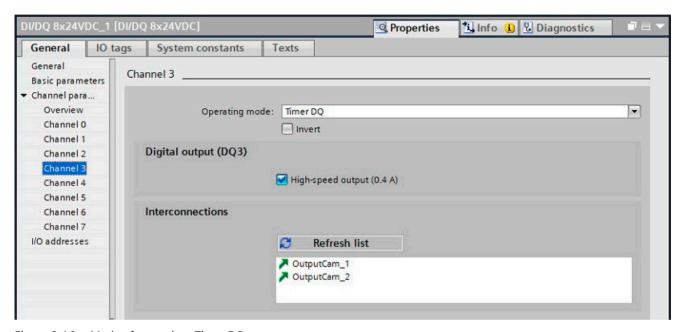
Figure 9-16 Mode of operation: Timer DQ
