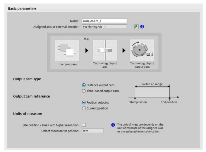
Figure 9-17 Basic parameters
