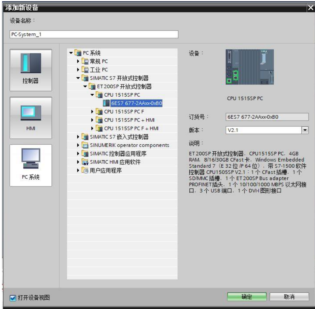
图 2 1515SP PC CPU 硬件组态
