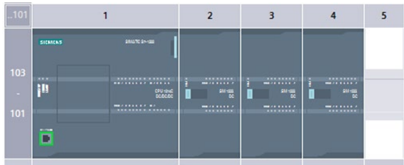
Рисунок 6-1 Конфигурация устройства для максимальной комплектации с тремя сигнальными модулями
