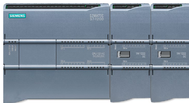
Рисунок 6-2 Фактическая конфигурация с отсутствующим модулем для слота 3 и сконфигурированным для слота 4 модулем в слоте 3
