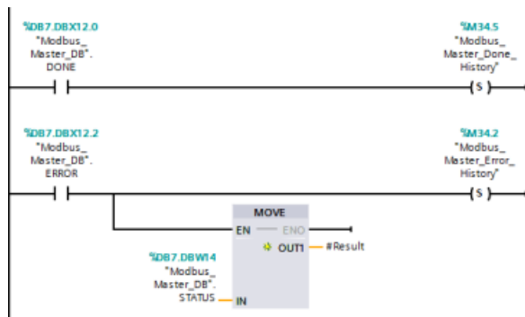
程序段 5: 写入完成后置位 DONE 历史位。一旦发生错误，该程序段将置位错误历史位并保存状态代码。
