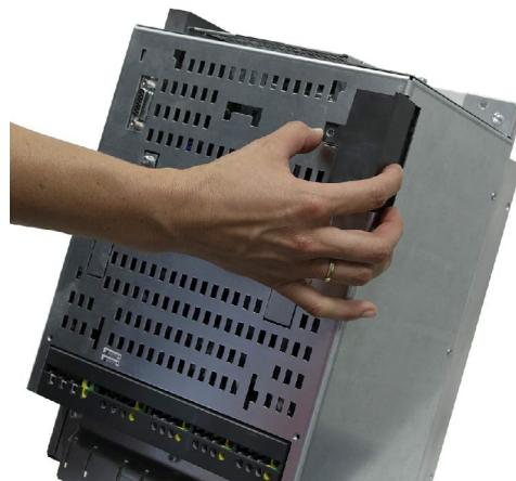
7. 取下直流母线侧面的盖板后，即可看到直流母线母排和 24 V 母排。
