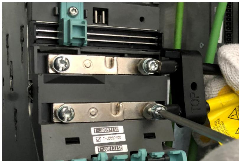
**说明：**在将直流母线电缆连接至附加组件时，始终将电缆的环形接线端子连接至附加组件直流母线母排上右侧的螺钉。此外，还需要注意电缆端子上的防呆设计。在连接环形接线端子时，须确保电缆端子上的防呆设计位于上方。
