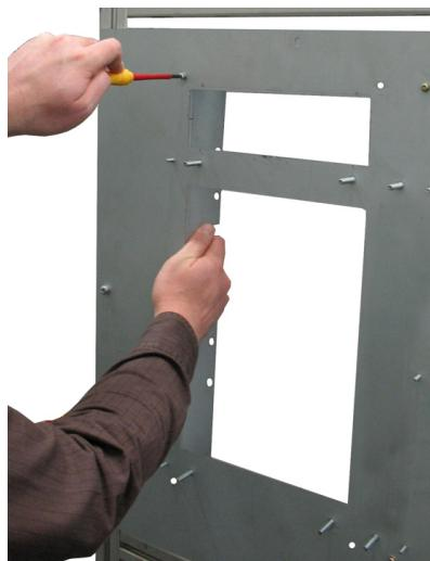
用螺钉拧紧加固板顶部和底部。
