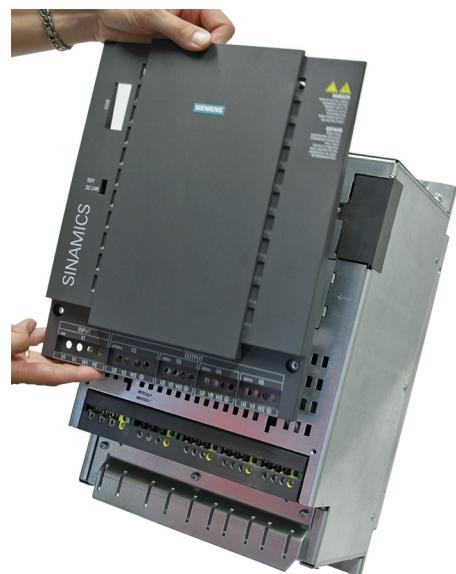
5. 取出直流母线盖板上的 Torx 带槽螺钉。
