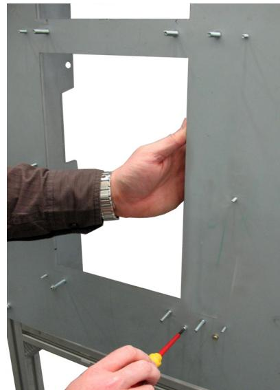
用螺钉拧紧加固板顶部和底部。
