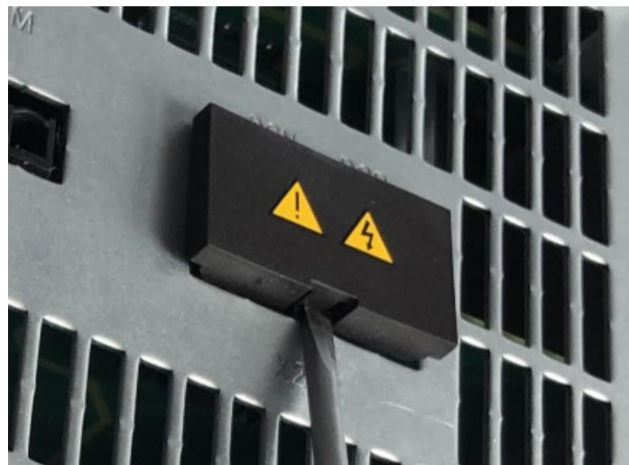
5. 将直流母线电缆插入接口 X228。
