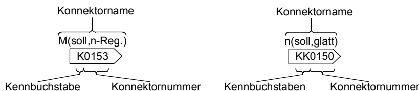
Bild 4-2 Darstellung der Konnektoren mit Wortbreiten 16 Bit und 32 Bit
