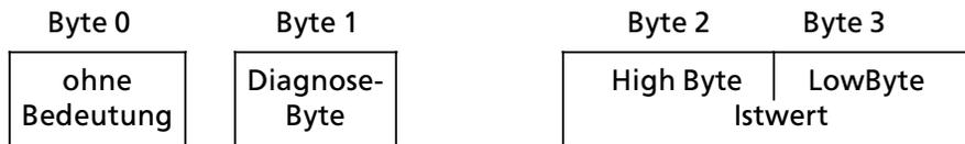
Bild 7.16 Daten von der Zählerbaugruppe an die CPU
