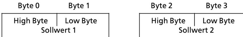
Bild 7.17 Daten von der CPU an die Zählerbaugruppe
