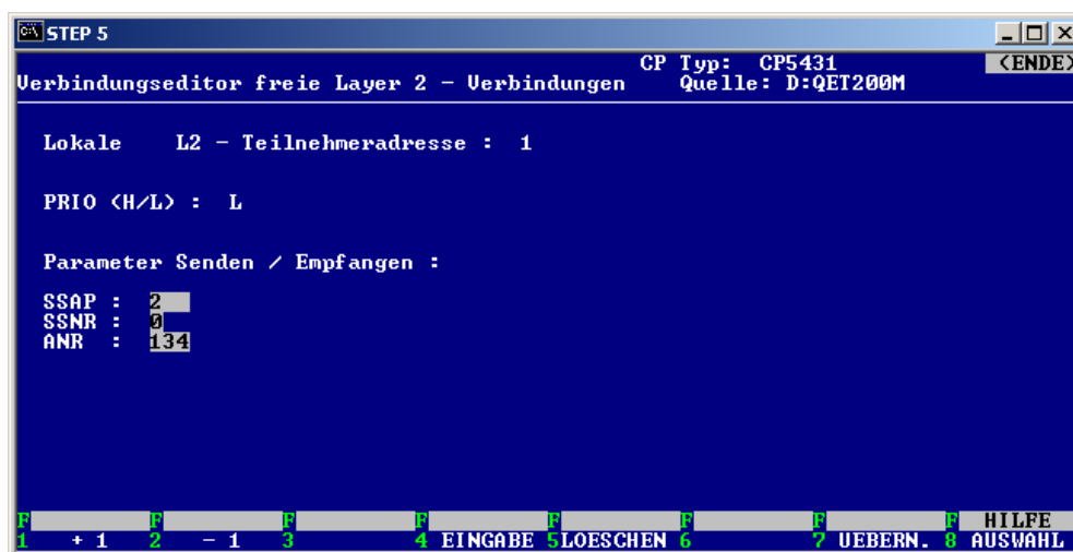
Bild 14: Freie Layer2-Verbindung auf CP5431
