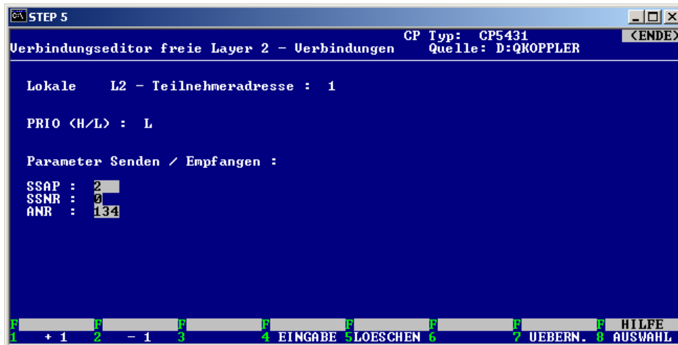
Bild 6: Freie Layer2-Verbindung auf CP5431
