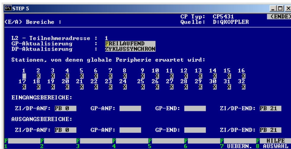
Bild 7: CP5431 E/A-Bereich, der von den projizierten Slaves belegt wird
