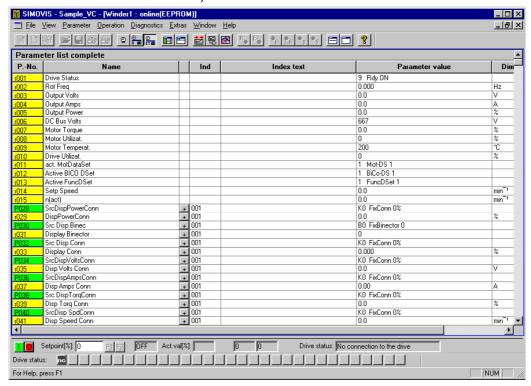
Fig. 5-27 Parameter list of all parameters
