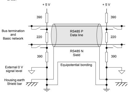
Fig. 8.1-12 Shielding and equipotential bonding
