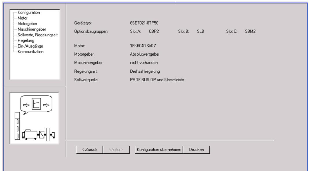
Bild 7-58 Geführte Inbetriebnahme Grundgerät: Zusammenfassung
