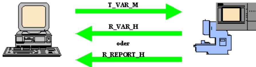
Die VisualBasic Applikation fordert den Wert eines R-Parameters mit dem RPC: **T\_VAR\_M()** an.
