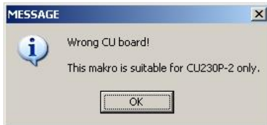
Fig. 4-5: Message, incorrect CU module
