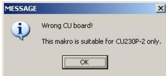
Fig. 4-5: Message, incorrect CU module
