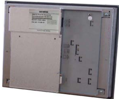
Bild 4-3 Fertig montierte Remote-Baugruppe an der SIMOTION-Panelfront
