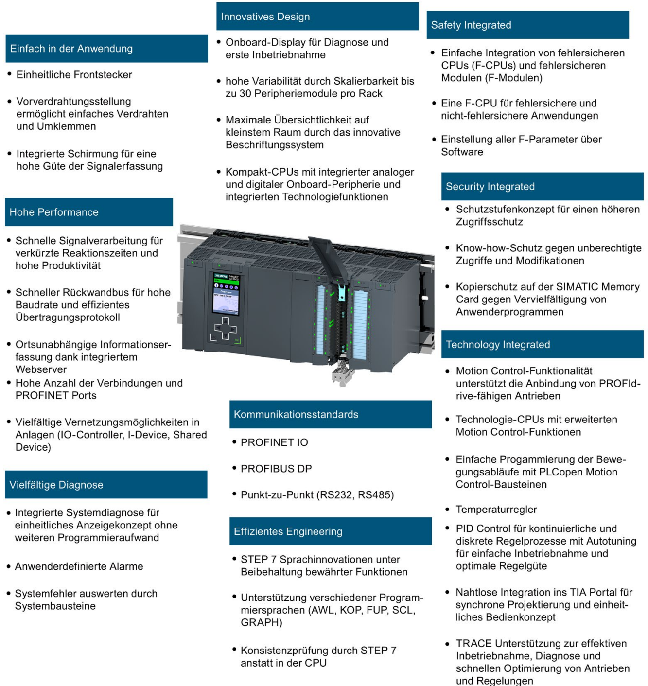
Bild 5-7 Automatisierungssystem SIMATIC S7-1500 - Eigenschaften und Funktionen
