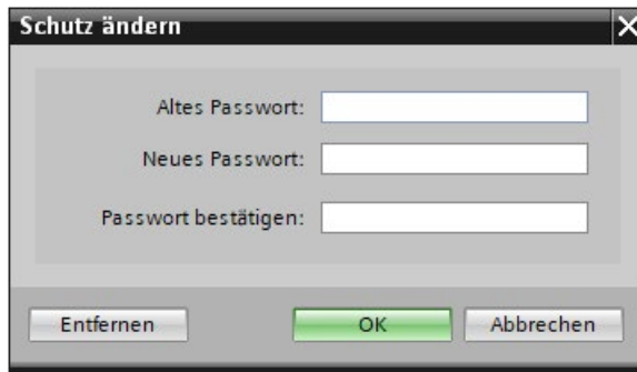
Bild 11-6 Know-how-Schutz für Bausteine entfernen
