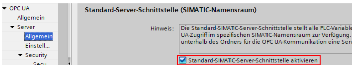
Bild 11-11 Standard-SIMATIC-Server-Schnittstelle des OPC UA-Servers
