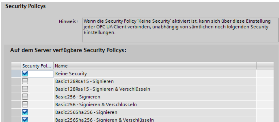
Bild 11-28 Security-Einstellungen des Servers konfigurieren
