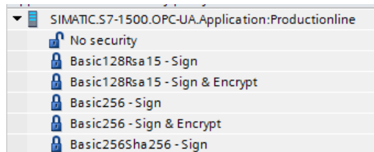
Bild 11-77 Gefundener OPC UA-Server mit allen Server-Endpoints
