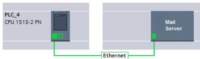
Bild 5-13 Secure OUC zwischen einer S7-1500 CPU und einem Mail Server
