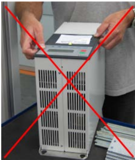
Kompaktgeräte heben - falsch
