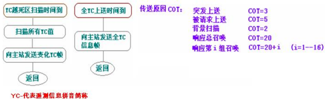
图 29: IEC104 规约遥测信息传送机制
