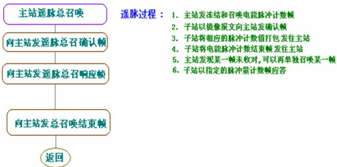
图 20: IEC104 规约中计数量召唤主站与从站的通讯机制
