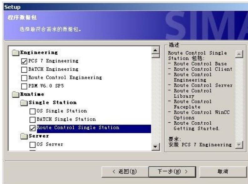
图 27 Route Control 单站的安装选项
