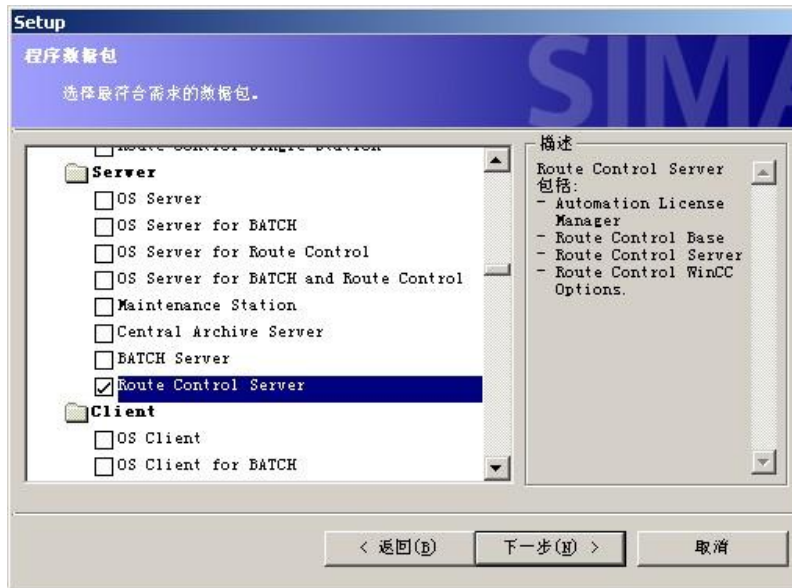
图 25 Route Control 服务器的安装选项
