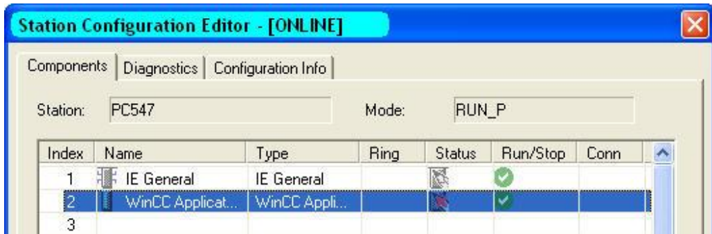
图 19 配置完组件的站编辑器
