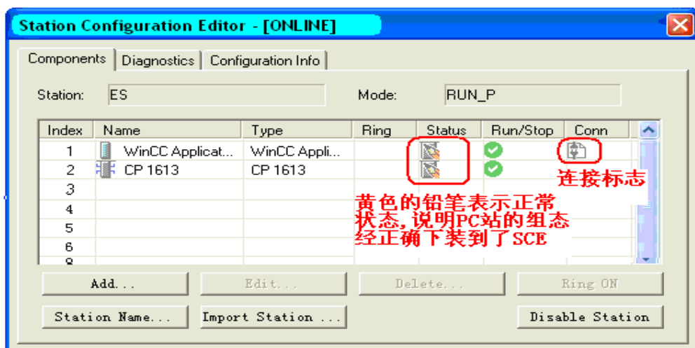
图 29 PC 站正确下载后 SCE 里组件的状态
