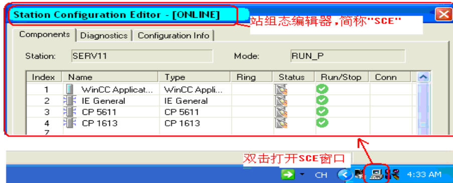
图 2 PC 站下载后 SCE 的状态图
