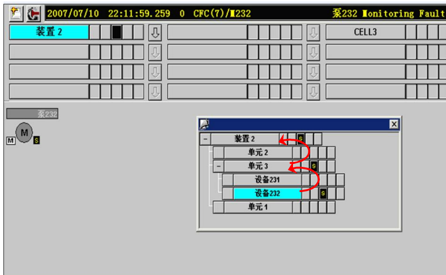
图 23：利用组显示实现 loop in alarm 功能
