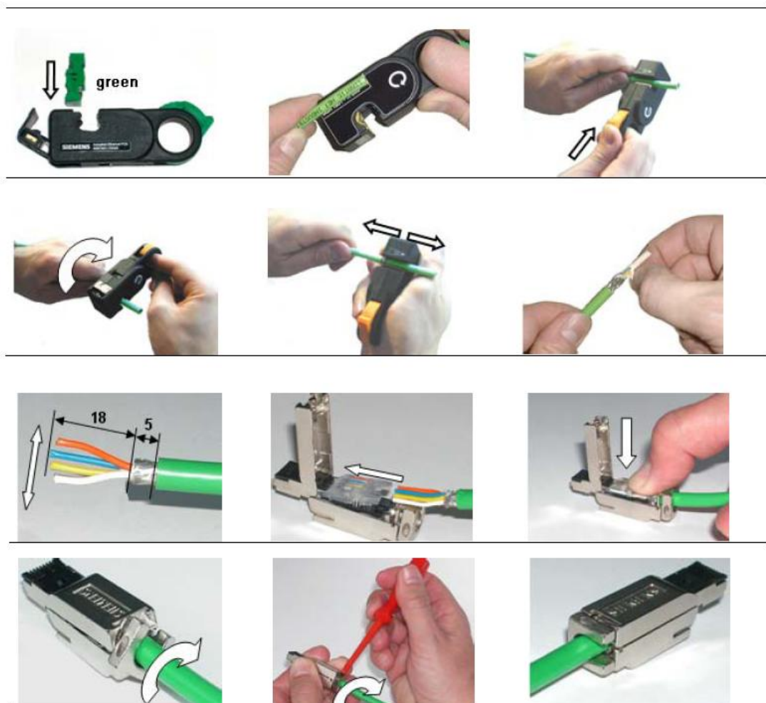
图 4 利用剥线工具进行快速安装
