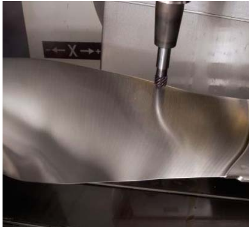
Schaufelblatt bei der Bearbeitung. Umseitiges Stirnfräsen bei Drehung um die X-Achse.
