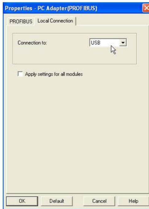
图 19 PROFIBUS DP 本地连接
