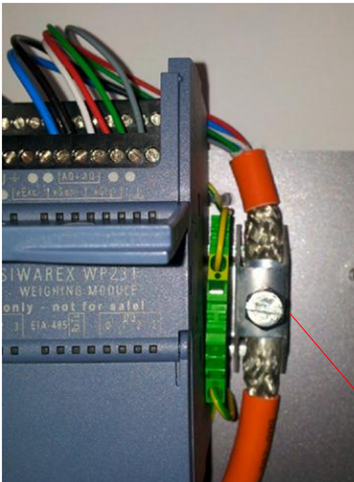
图 2-2 称重传感器接线及屏蔽层的处理
