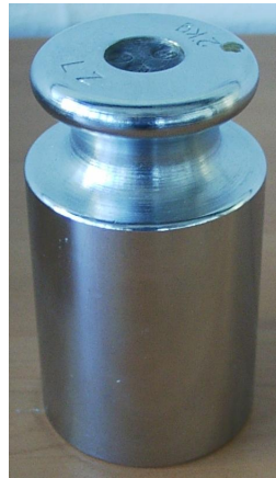
标定砝码（重量必须大于传感器量程总和的 5%）
