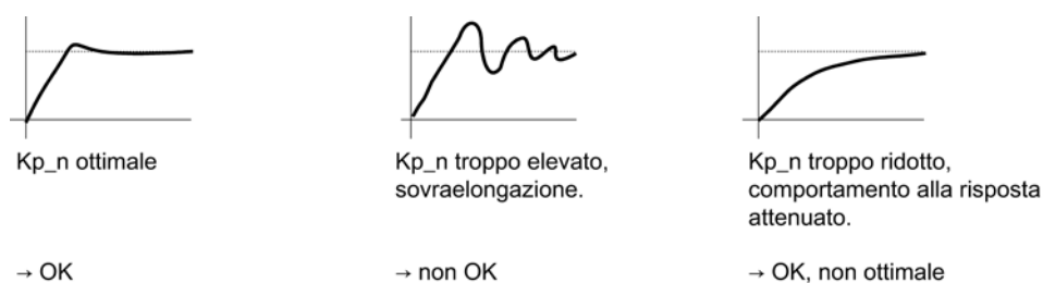
Figura 4-14 Impostazione del guadagno proporzionale K_p
