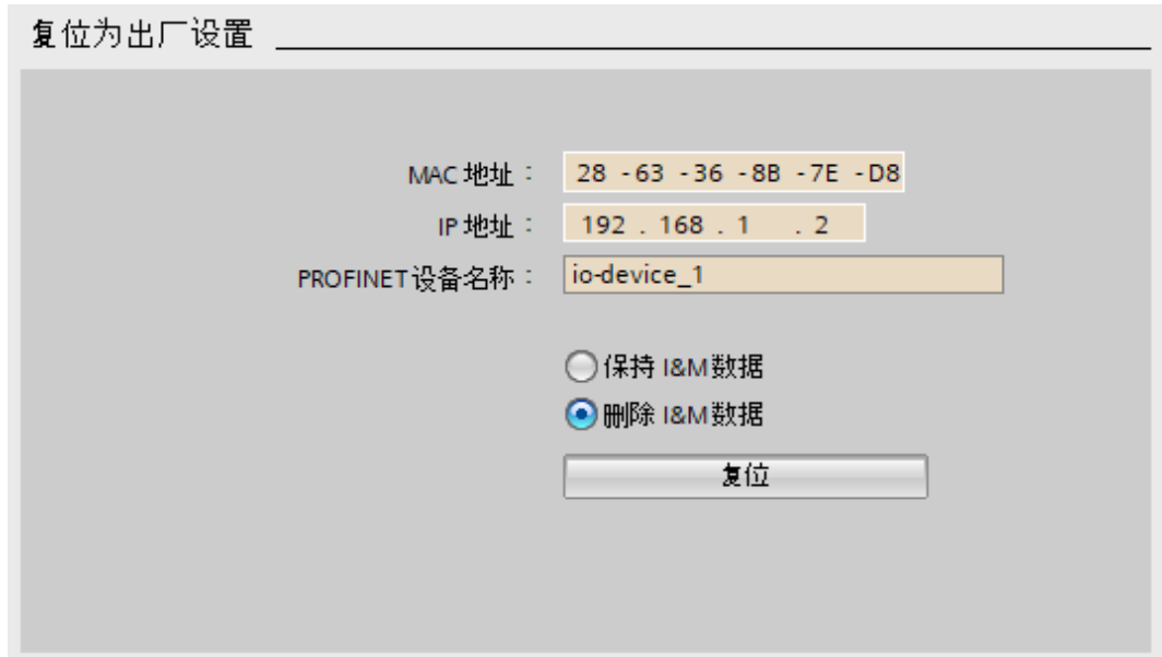
图 4-2 将接口模块复位为出厂设置
