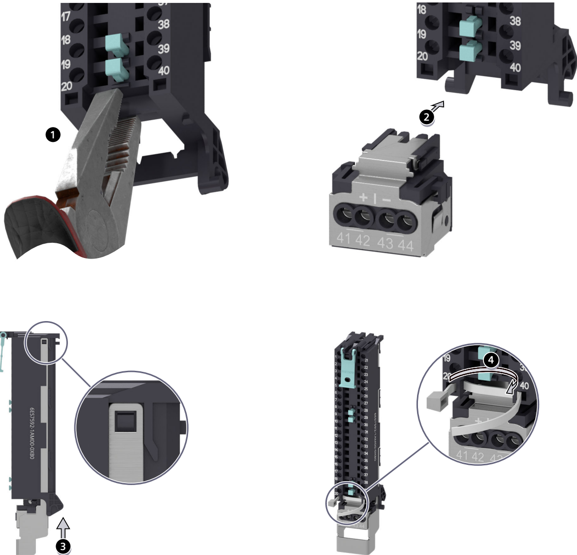
图 8-12 准备带屏蔽端子元件的 I/O 模块的前连接器 (1)
