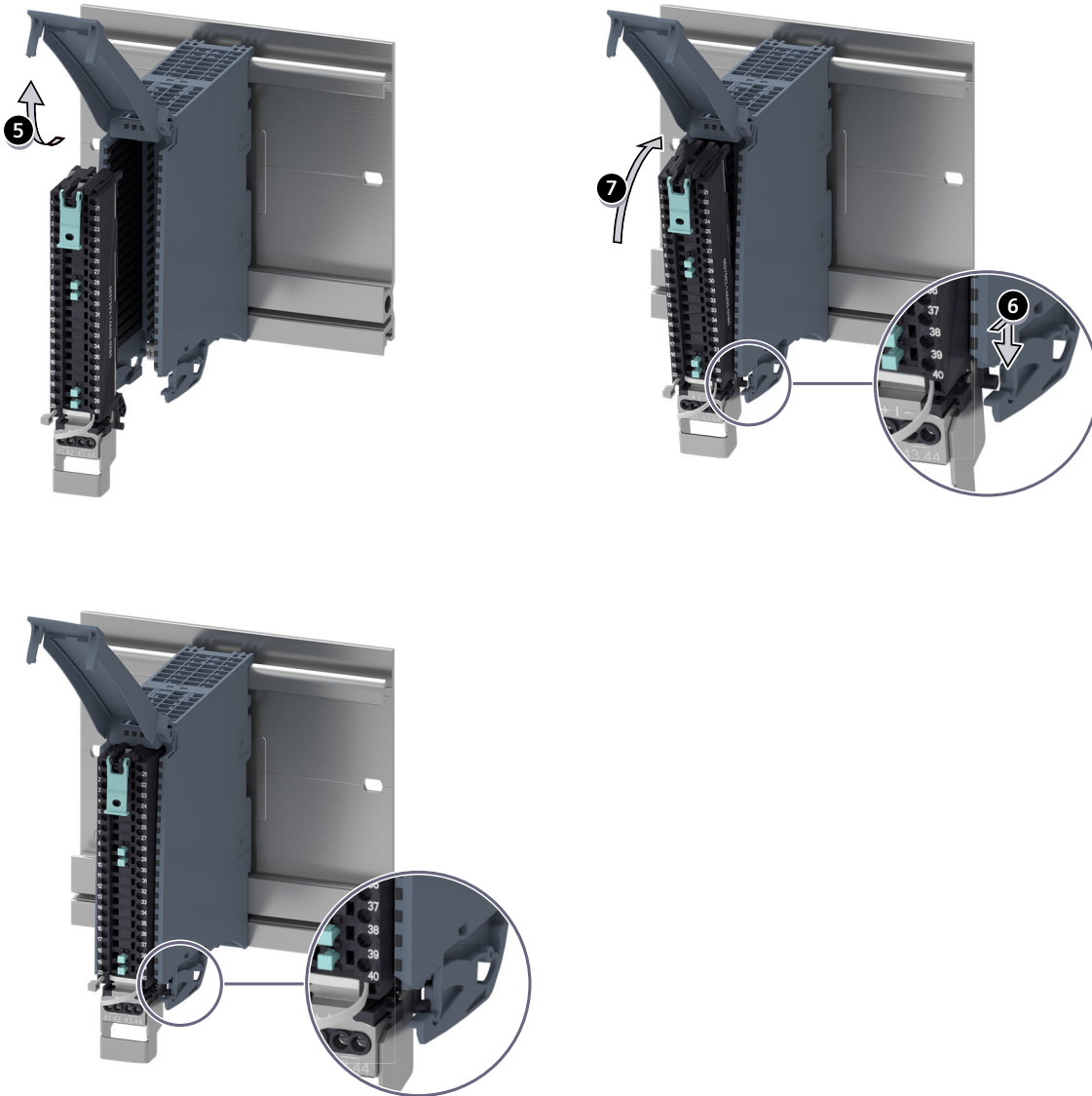
图 8-13 准备带屏蔽端子元件的 I/O 模块的前连接器 (2)
