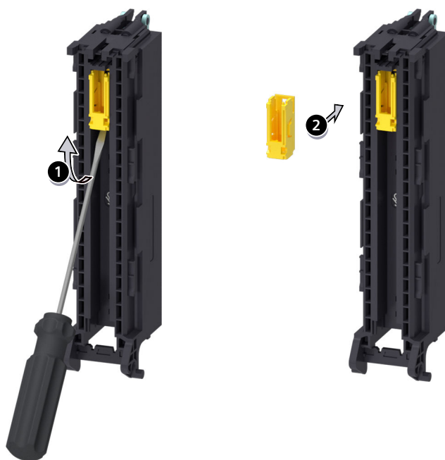
图 15-10 从前连接器移除电子编码元件并插入新的前连接器中
