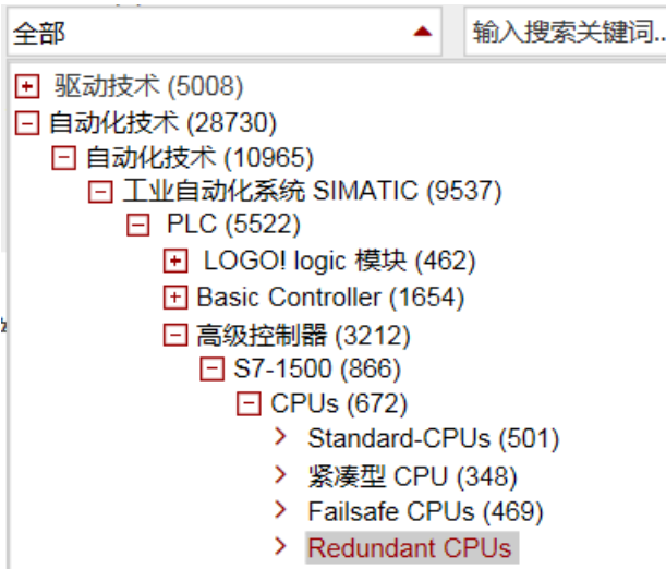
图 15-13 以 S7-1500 为例的产品导航 : 在此位置, 可浏览到待更新的特定类型模块。单击“支持”(Support) 下方的链接“软件下载”(Software downloads), 继续操作。保存所需的固件更新文件。
