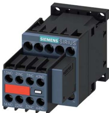
Силовой контактор, AC-3 7 А, 3 кВт/400 В 2 НО + 2 НЗ, 110 В AC 50 Гц, 120 В, 60 Гц, с установленным варистором, 3-пол., типоразмер S00 винтовая клемма несъемный блок вспомогательных выключателей
