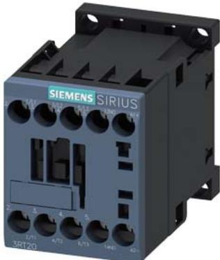
Силовой контактор, AC-3 7 A, 3 кВт/400 В 1 НО, 24 В DC 0,7–1,25\* US, встроенный диод, 3-пол., пригоден для выходов ПЛК без возможности установки вспомогательного выключателя
